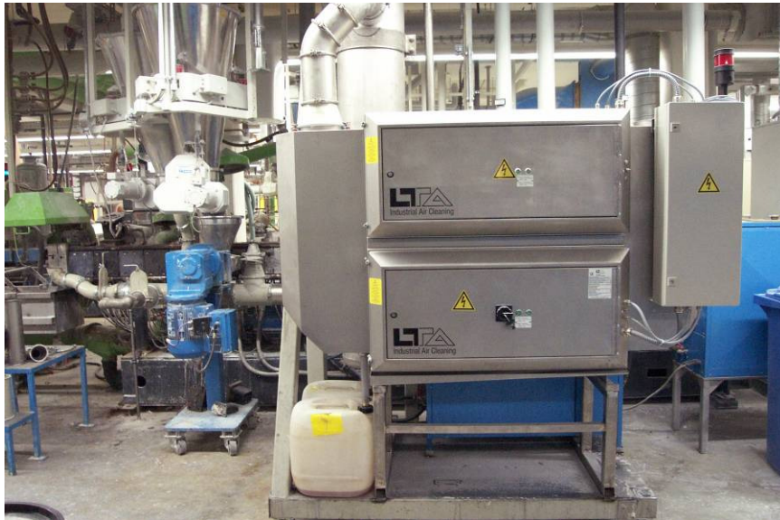
LTA-Luftfilter vom Typ AC 3021-V-A in Edelstahlausführung
